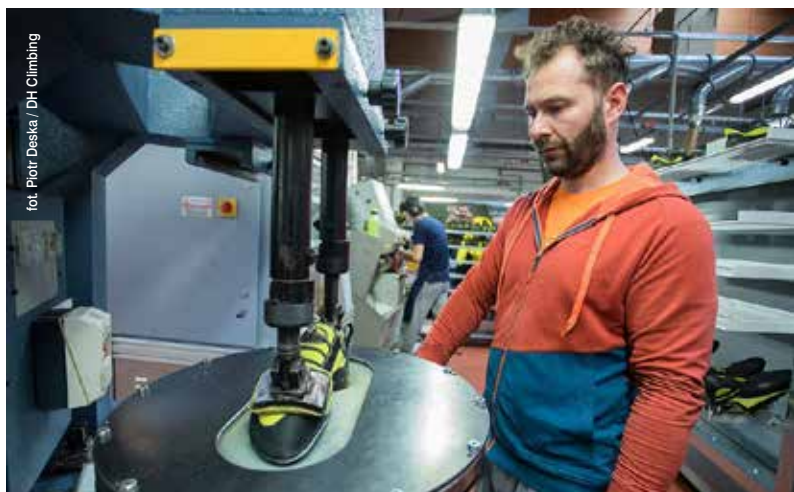
Specjalna prasa ułatwia odpowiednie sklejenie podeszwy i cholewki
